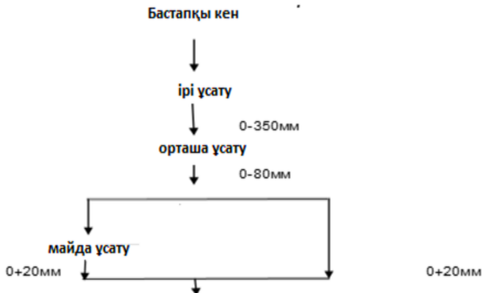
1.1.2 сурет – Ұсату схемасы
